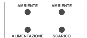
DISPOSIZIONE DEL SENSORE DI PRESSIONE SU PCBA
